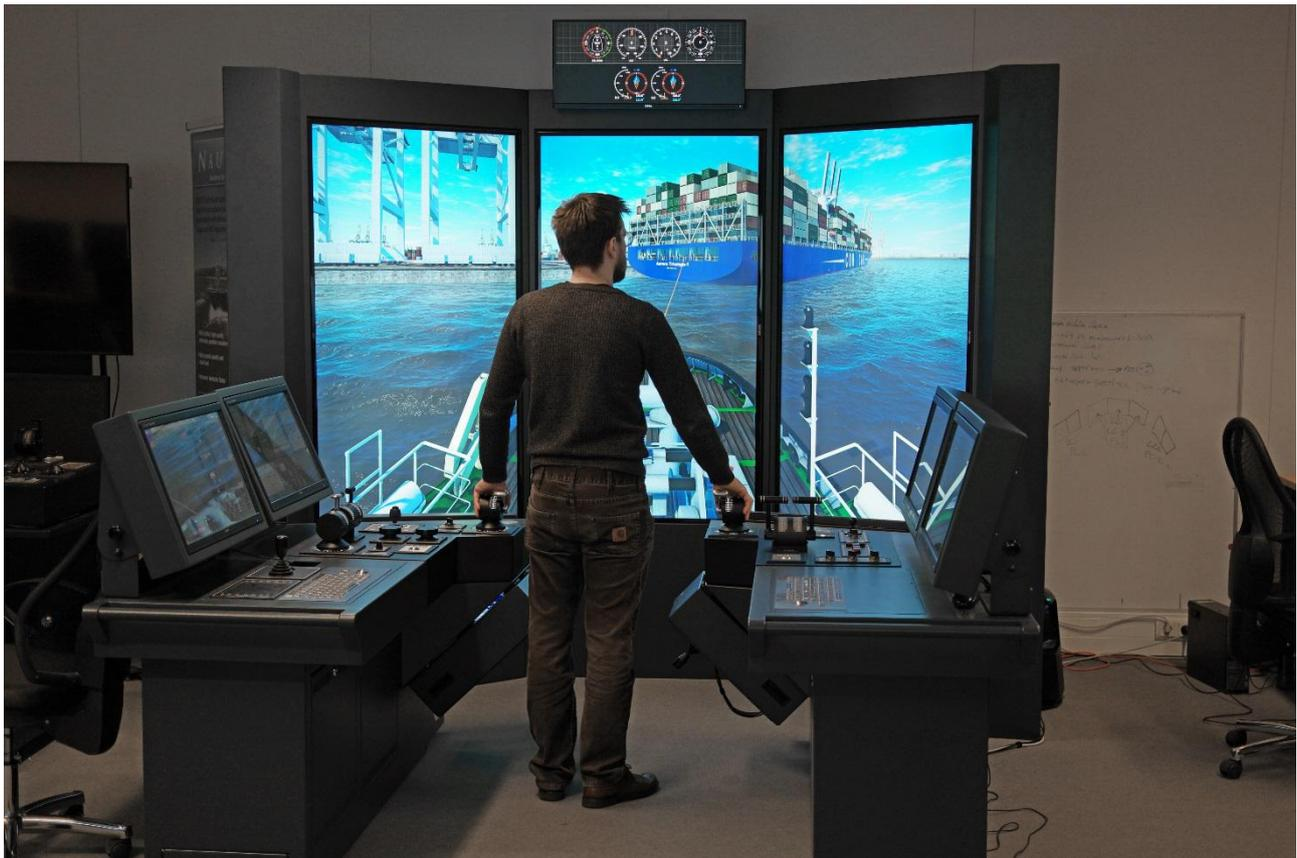
Figura 18. Simulador de remolcador con un campo de visión horizontal de 1200 que ejecuta NAUTIS 3 en tres pantallas LCD verticales de 65".
