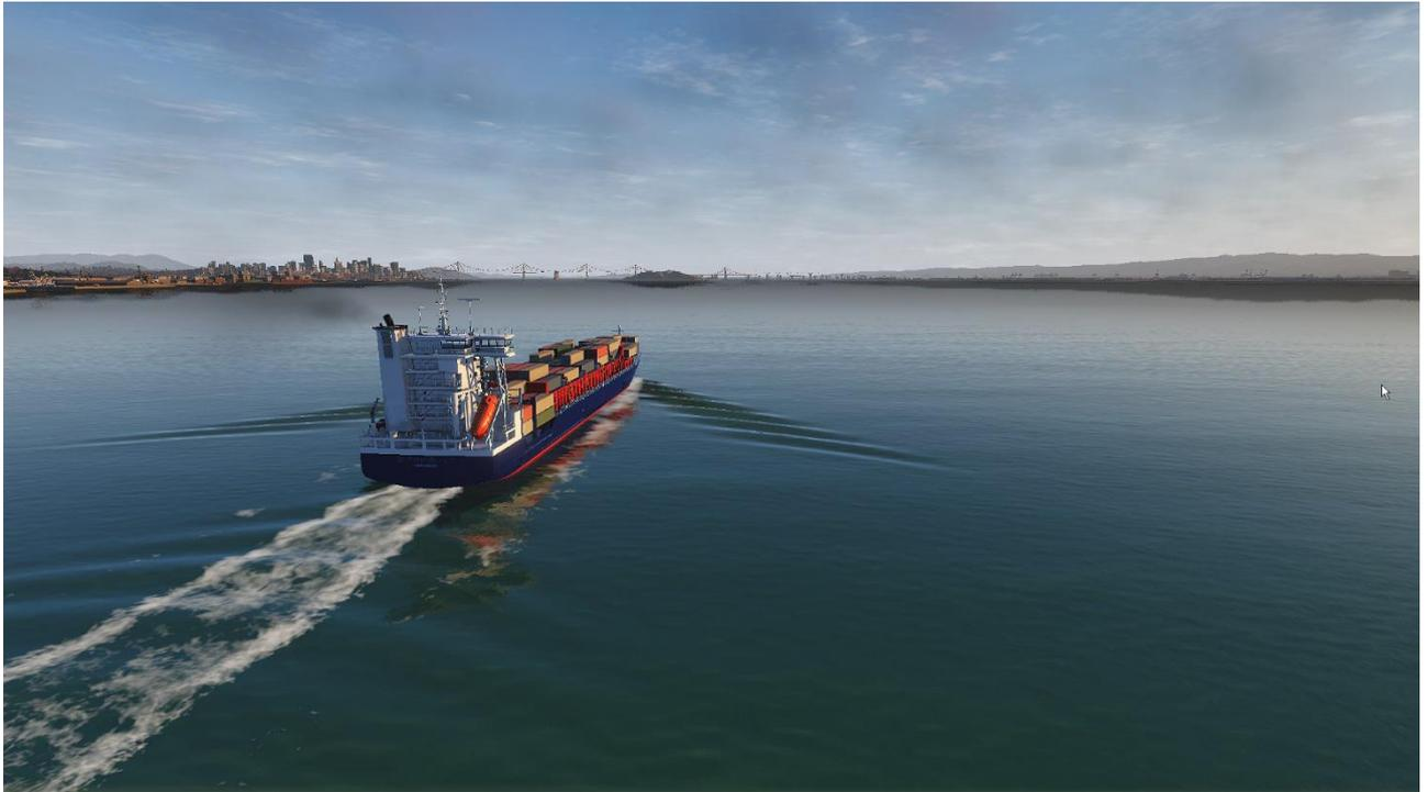
Figure 9. Olas de proa y popa y turbulencias alrededor y detras del casco.
