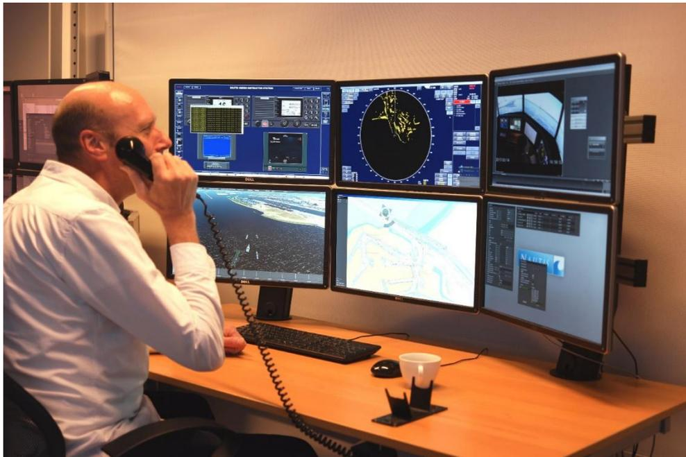
Figura 6. Típica estación de instructor DNV Clase A FMBS con 6 pantallas conectadas a una PC. El instructor coloca algunos de los cuadros de diálogo en la pantalla inferior derecha, para mantener la vista 3D (inferior izquierda) y la vista de gráfico 2D (inferior central) despejada.
