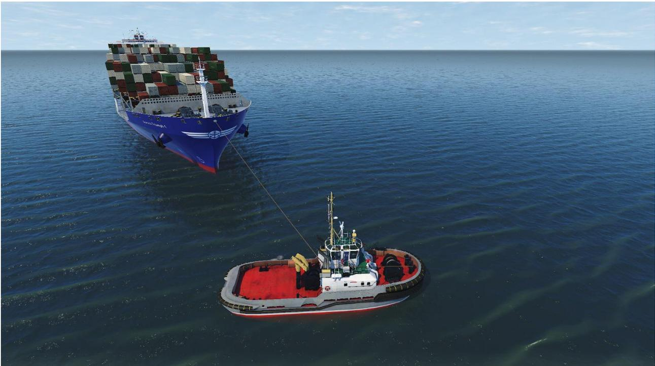
*Figura 15. El nuevo sistema de cables hace posible que las líneas de remolque puedan experimentar obstrucción por otros objetos, como en el caso anterior, la caseta del remolcador.*
